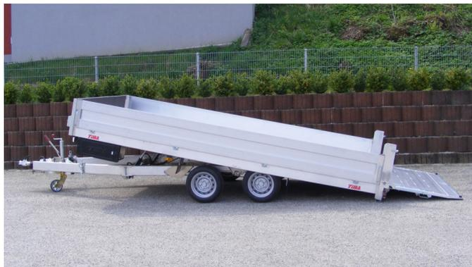
**ATPHK – der ideale Kippanhänger mit Ladefläche über den Rädern und flachem Auffahrwinkel zum Transport von Maschinen und Geräten**
