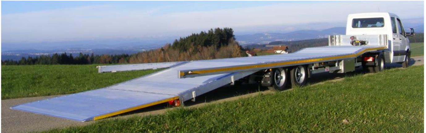
ATSA-HS-W – der ideale Zweiachs-Sattelauflieger mit gekröpftem Schwanenhals, absenkbarem Heckteil und Auffahrwand mit flachem Auffahrwinkel zum Transport von Geräten, Maschinen und Autos.
