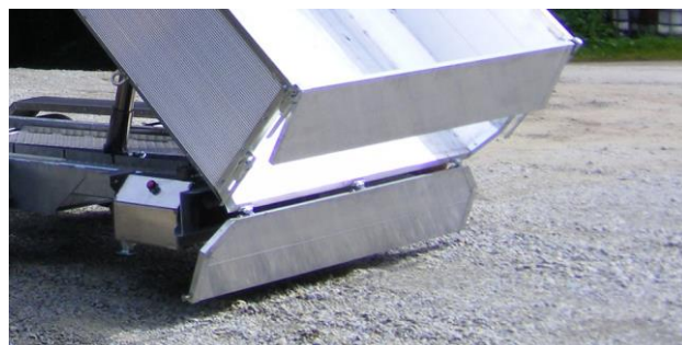
Seitenwände unten abgeschrägt, Zurrmulden innen
